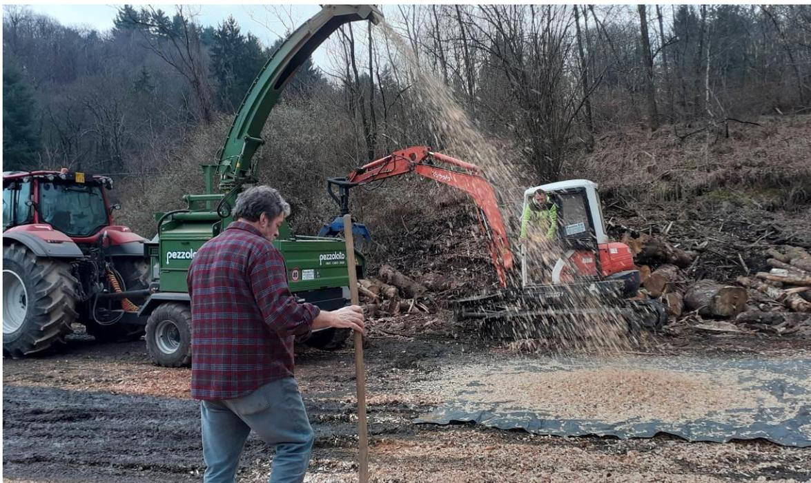
*Foto 18 cippatura del materiale per le successive analisi*
